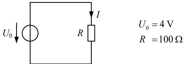
À l'aide de la loi d'Ohm, exprimer la relation qui permet de calculer le courant  $I$  à partir de la tension  $U_0$  et de la résistance  $R$  :
