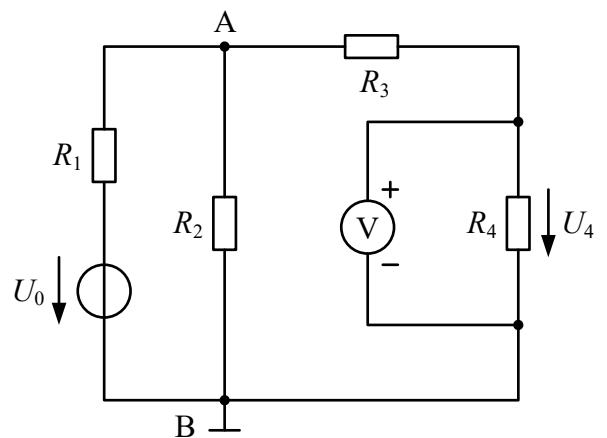
Réaliser les montages et mesurer les 3 tensions  $U_2$ ,  $U_3$  et  $U_4$  à l'aide du multimètre **HMC8012**.
