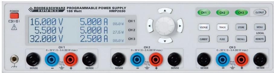
Utiliser le canal de sortie **CH 1**.
